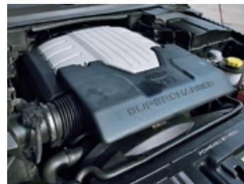
Moderne(s) Plastik: 4,8-Liter-Kompressor-Kraftwerk unter Abdeckung
