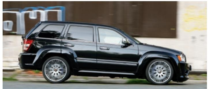
Voll Keil: extreme Tieferlegung an der Vorderachse. Dank Gewindefederbeinen kann man sich vorn aber auch mal etwas mehr Federweg gönnen
